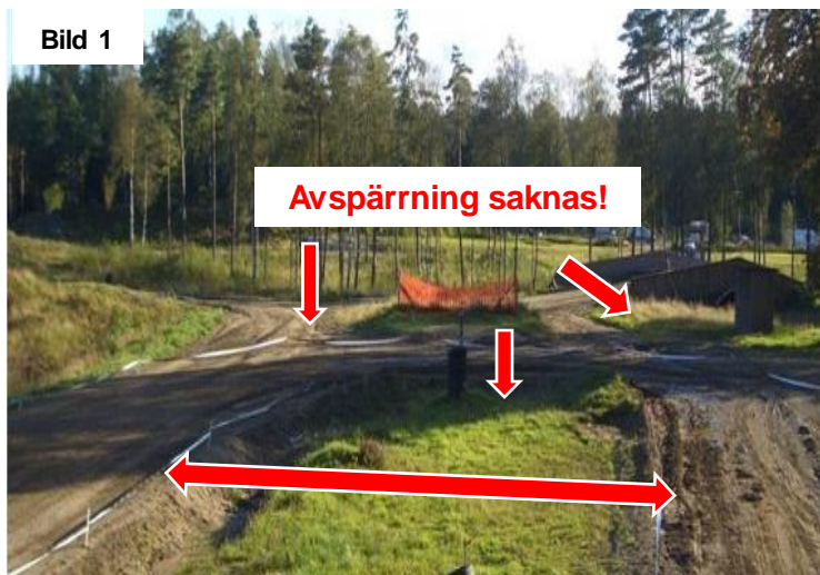
Avståndet är mindre än 9 meter mellan banmarkeringar vilket kräver avspärrning mellan banslingorna, som saknas på denna bild.
